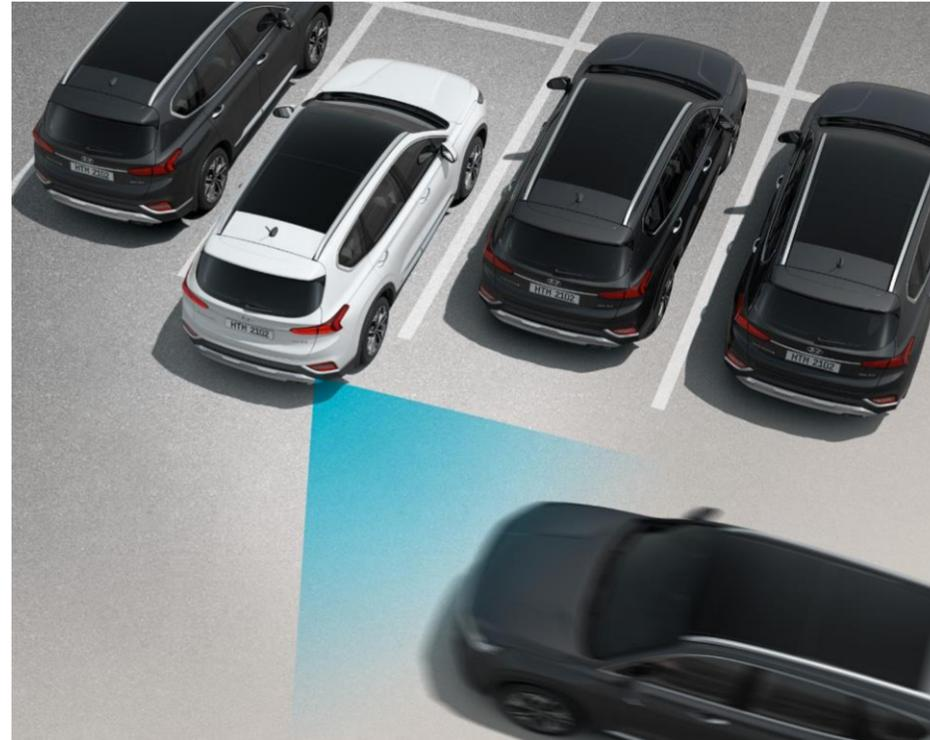
Advertencia de colisión frontal tráfico cruzado (Rear Cross-Traffic Collision Warning, RCCW)
