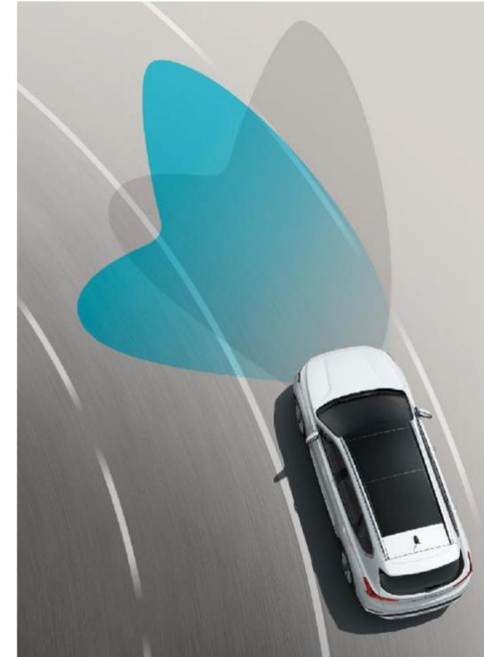
Asistente dinámico luces de cruce (Low Beam Assist-Dynamic,LBA-D)
