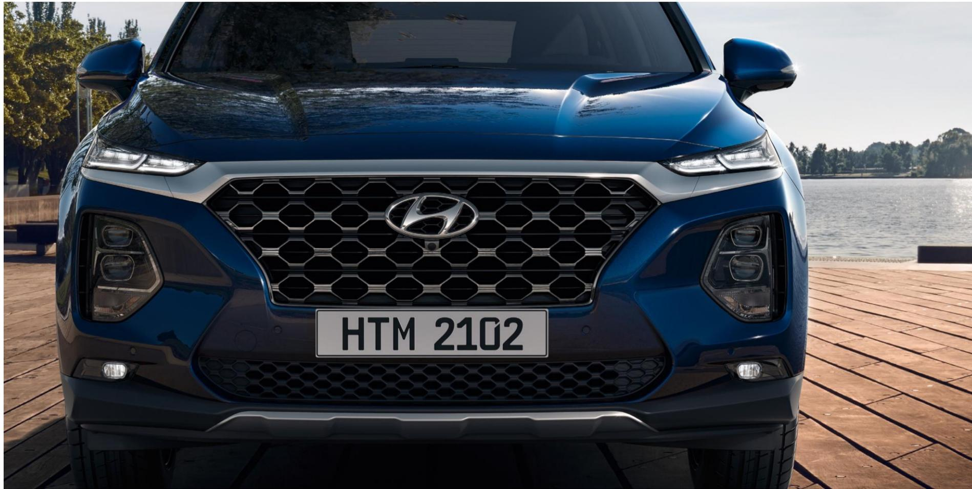
Grilla del radiador /Luces LED de circulación diurna (DRL) / Focos delanteros LED / Luces antiniebla LED
