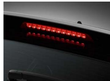
Luz de freno LED colocada en alto
