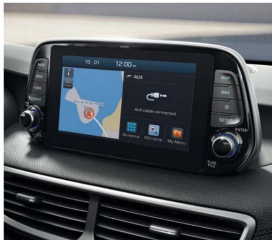
Pantalla táctil LCD de 8" tipo flotante
